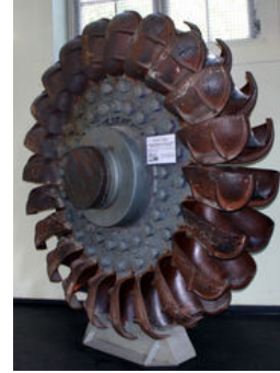
Şekil.1.4.b. Bir akışkan kuvveti ile hareket sağlayan türbin
